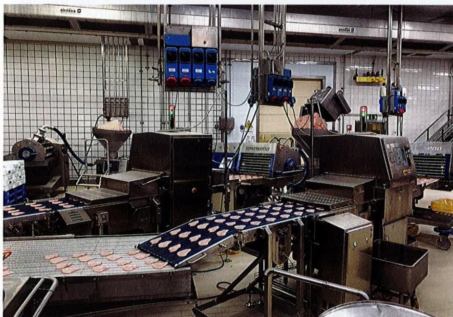
Per il trasferimento fluido e graduale anche in velocità dei prodotti dalla formatrice a monte verso il nastro a valle, i trasporti interni alla macchina adottano una soluzione "a penna" di piccole dimensioni (Parmacontrols).
